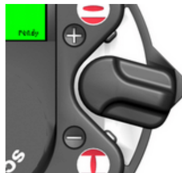
Bild 44: Leichte Auslenkung des Schalters (es wird zum nächsten Parameter gesprungen)
