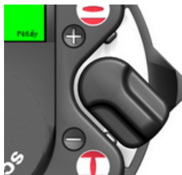
Bild 46: Vollständige Auslenkung des Schalters (es wird an das Ende des Menüs gesprungen)
