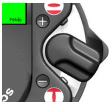
Bild 45: Mittlere Auslenkung des Schalters (es wird zur nächsten Parameterkategorie gesprungen)
